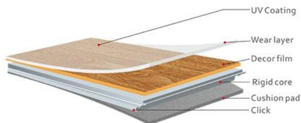
**IL SOTTOPAVIMENTO IN SUGHERO DEI NOSTRI PAVIMENTI IN SPC ASSICURA MIGLIORE STABILITA' DIMENSIONALE, RESISTENZA DI CARICO, ISOLAMENTO TERMICO E ACUSTICO IDONEO PER PAVIMENTI RADIANTI.**
